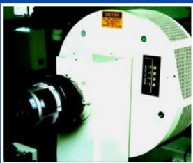
Der DF-2000 montiert auf einem typischen, achslosen Abrollständer.
