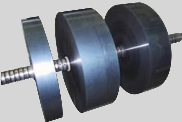
L'arbre expansible à friction est un arbre à réglettes avec des bagues à double rangée de billes. Les réglettes sont en polymère ou polyzène ou feutre de manière à faciliter la friction entre le diamètre intérieur des bagues et la table de l'arbre. Le tube principal (la table) est en acier chromé et rectifié. Il est utilisé pour l'enroulage de plusieurs bobines avec variations d'épaisseurs. Ce modèle est disponible dans les diamètres 70, 76, 150 et 152.4 mm.
