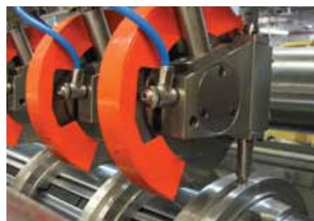
Pion de jonction permet un positionnement simultané du porte-couteau et contre-couteau.
