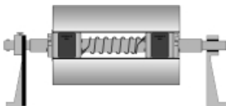
Embouts pneumatiques UC-3000 montés sur flange et au centre, avec accessoire optionnel du tuyau de branchement
