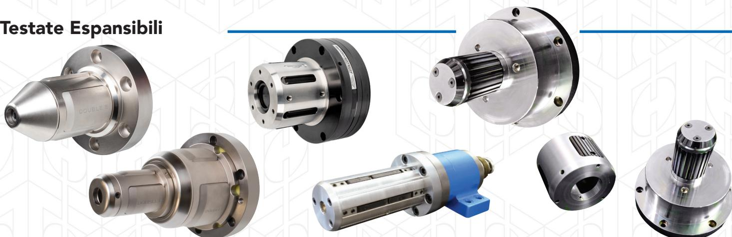
Le testate espansibili Double E Group sono generalmente utilizzate per la presa tra punte delle bobine. Possono essere a serraggio meccanico auto-espandente, pneumeccanico con pistone oppure pneumatico a membrana.
