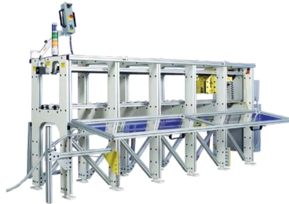
ESH-1000-S heavy-duty feststehender Shaftpuller mit fester Höhe für Spannwellen bis 500 kg und einer Länge bis 4000 mm. In Verbindung mit einem Hubtisch auch mit verstellbarer Höhe.
