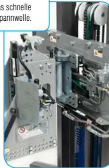
Ein Drehgelenk zum leichteren Einführen und Herausziehen der Spannweile aus der Hülse.
