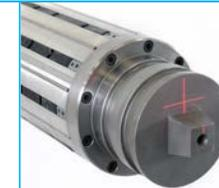
Manuelle, elektrische oder hydraulische Seitenverstellung erleichtern das schnelle Ausrichten der Aufnahme zur Spannweile.
