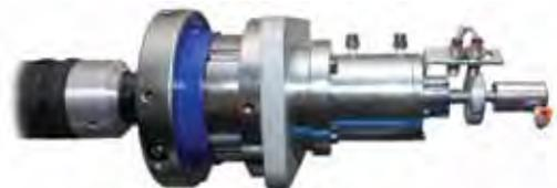
Sicherheitslager mit dem optionalem Sensor für Belüftungsdornposition.
